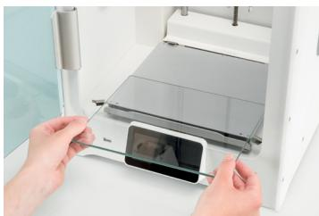
4. Deslizar a placa de vidro de modo a esta entrar nos grampos traseiros da base de construção e, em seguida, fechar os grampos frontais e a porta de vidro
