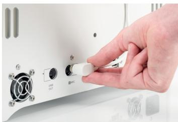
2. Ligar o cabo do suporte de bobinas à entrada NFC e fixá-lo utilizando os grampos de fixação de cabo
