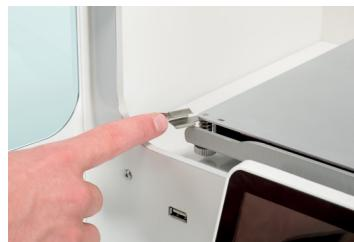
3. Abrir a porta de vidro e os grampos frontais da base de construção para introduzir a placa de vidro
