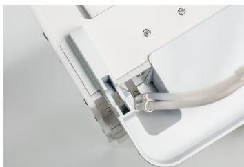
2. Guie o cabo da cabeça de impressão e os tubos Bowden para o interior das fendas de cada lado do suporte. Os tubos Bowden devem ser colocados à frente
