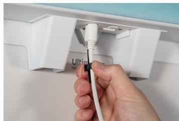
9. Coloque o grampo de alívio de tensão fixado ao suporte de montagem em torno do cabo do Air Manager e feche-o
