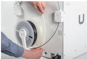
11. Passe o cabo do Air Manager pelo lado direito à volta do suporte e ligue-o à porta **UMB OUT** na parte de trás do Ultimaker S5
